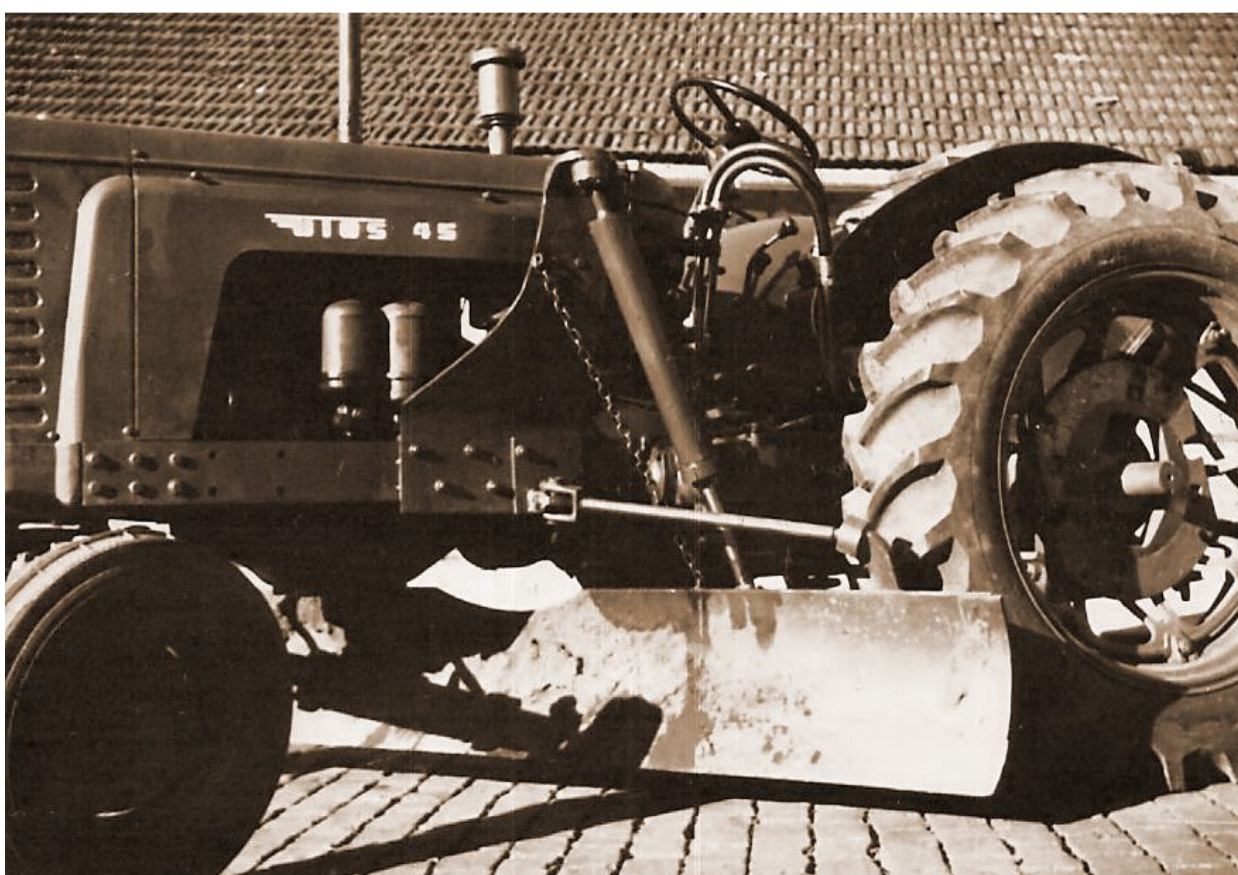
Patrol – trator equipado com lâmina para realizar pequenos trabalhos de nivelamento das estradas. Acervo da Câmara
