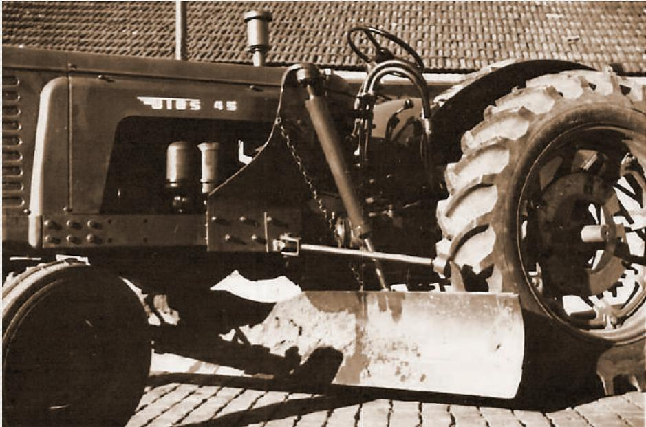
Figura 51: Patrol - trator equipado com lâmina para realizar pequenos trabalhos de nivelção das estradas -1962.
