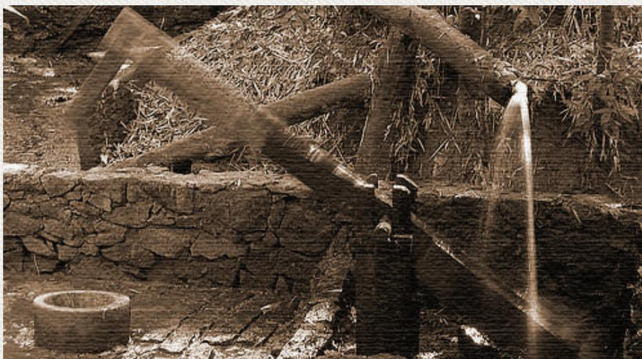
Figura 03: Monjolo, semelhante aquele utilizado pelos caboclos antes da colonização de São Lourenço do Oeste.
